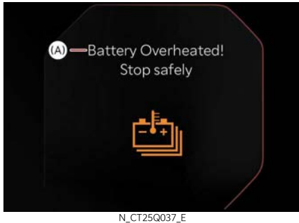
(A) Batteriet är överhettat! Stanna säkert
