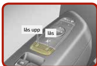
Manövrera dörrlås från insidan med centrallåsomkopplaren [4]
