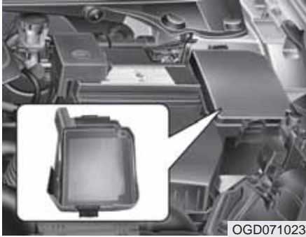
Säkringshållare i motorrummet (bil med Turbo GDI bensinmotor) Lockets insida ->
