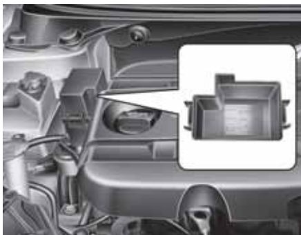
Lockets insida i den extra säkringshållaren i bilar med dieselmotorer
