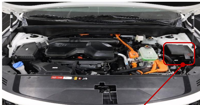
Quadro elettrico vano motore
