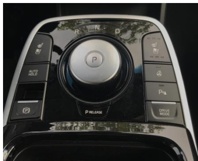
Azionare il freno a mano elettronico (EPB)
