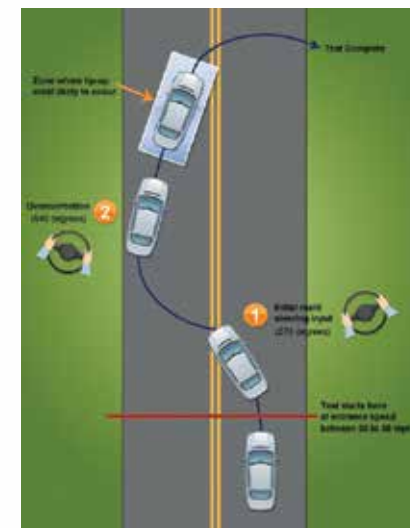
Az amerikai NHTSA kikerülési manőverének rajza. A baleset elkerülésében oroszlánrésze van a vezető reakcióidejének és az úgynevezett rizikóviselkedésének is. Utóbbi valójában a sofőr helyzetfelmérési képessége
