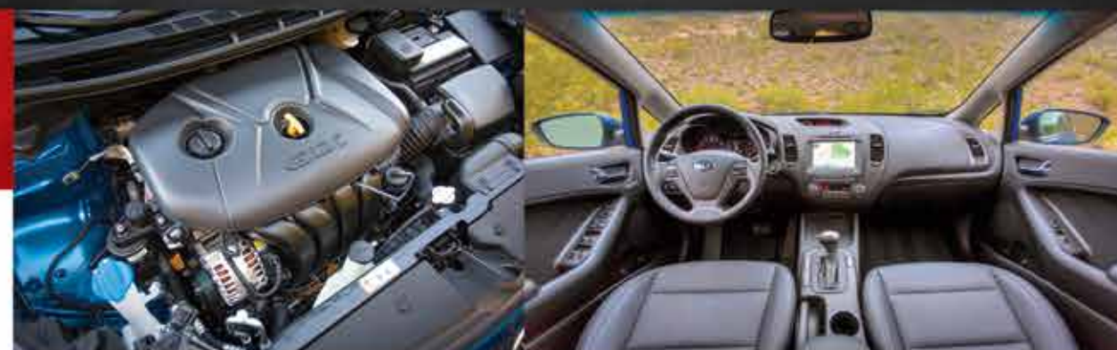
173 LE-s a 2,0 l-es, közvetlen befecskendezéses szívó benzinmotor
