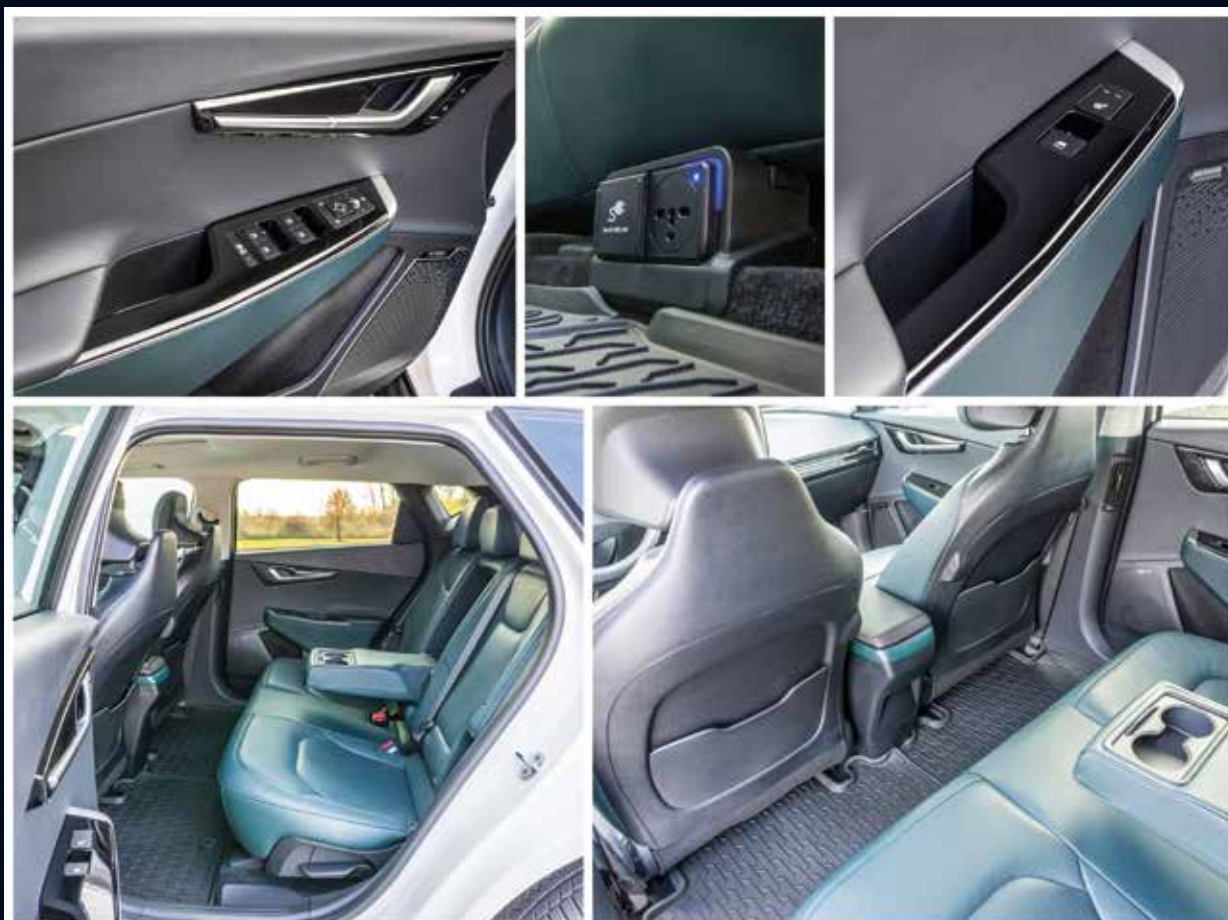
Középen a V2L kétirányú töltő konnektora a hátsó ülőlap alatt
