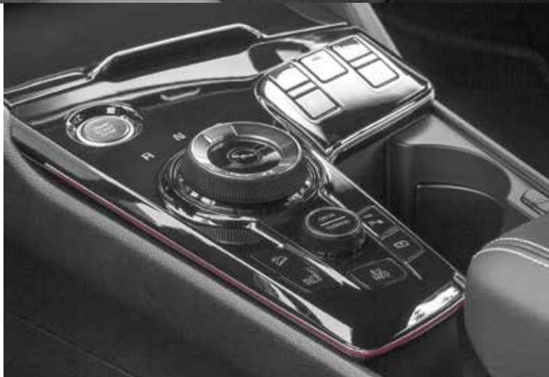
Forgótárcsa lett a hagyományos váltókar, alatta a kisebb tekerő a menetvezérlő szabályzója
