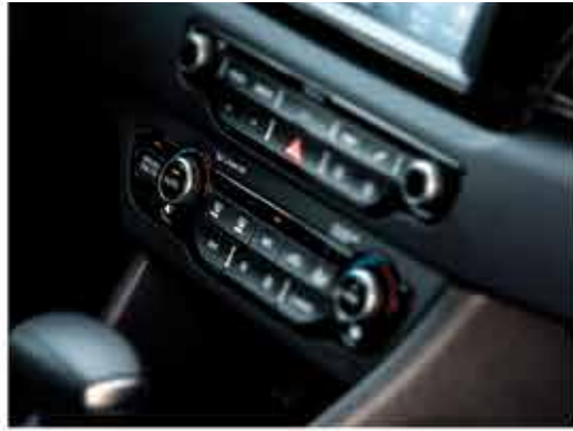
Driver only – gombnyomásra csak a vezető oldalán aktív a szellőzés, illetve a légkondi – így csökkenthető a fogyasztás
