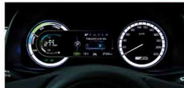
Kömmen értelmezhető és minden napszakban remekül leolvashatók a Supervision műszerek. Balra alul a zöld EV felirat az elektromos üzemről tájékoztat, közepen az energia „áramlása” követhető
