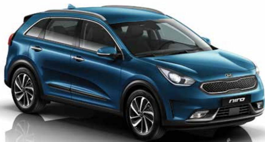
Kia Niro – 1,6 l-es GDI benzínmotor, villanymotor és hatfokozatú, duplakuplungos automata sebességváltó alkotja a hibrid hajtásláncot. A garancia erre a modellre is 7 év vagy 150 ezer km
