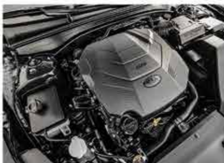
Hatásos zajszigetelő burkolat alatt forog a keresztben beépített 3,3 l-es, V6-os benzines. A hajtás az első kerekeké, a váltó nyolcszelepes automata
