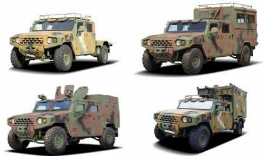
Ezek a KM1 Light Tactical Vehicle (LTV) alapmodelljei: balra négyszemélyes, páncélozott parancsnoki jármű, középen nyolcszemélyes, páncélozott csapatszállító, jobbra pedig a többcélú kivitel
