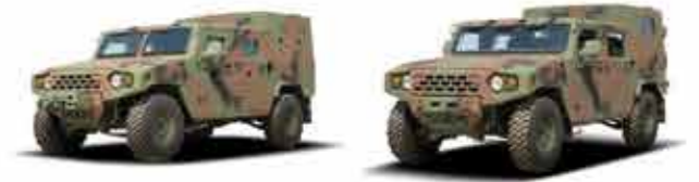
Ezek a KM1 Light Tactical Vehicle (LTV) alapmodelljei: balra négyszemélyes, páncélozott parancsnoki jármű, középen nyolcszemélyes, páncélozott csapatszállító, jobbra pedig a többcélú kivitel
