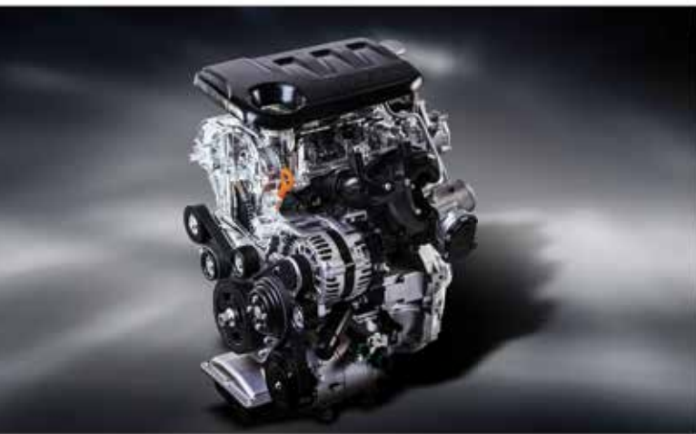
Az új háromhengeres a korábbi szívómotorra épül, de sok részlete más, blokkját alu főtengelycsapágy-keret merevíti
