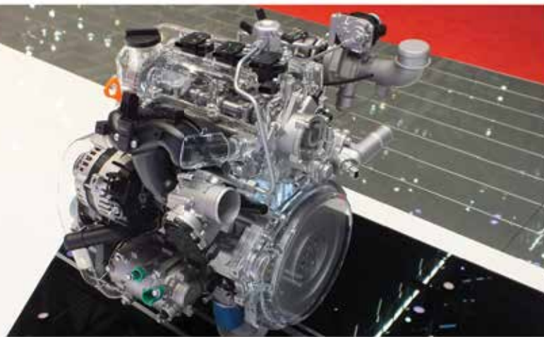
Jobbra fent a turbó lefúvató szelepeinek elektromos mozgatómechanizmusa látható
