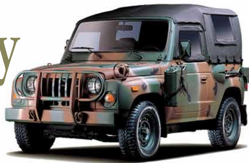
Vászon tetős KM420 alapmodell, katonai kiegészítőkkel (marmonkanna, gyalogsági ásó). A fényszórókat rács védi, az irányjelzők alá légóltalmi lámpákat szereltek
