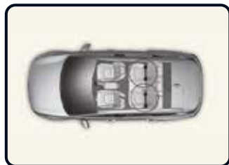
ISOFIX-kiinnityspisteet ja ylähihna-kiinnitys (ISOFIX-kiinnitysjärjestelmä) lapsille [4]
