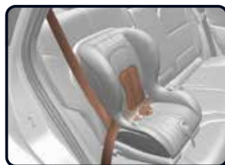
Lapsen turvaistuimen asentaminen lanne-/olkaturvavyöllä [3]
