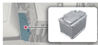
Batería en el compartimento del motor
