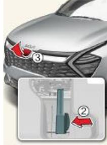
1. Tire de la palanca de apertura ① para desbloquear el capó. El capó deberá abrirse saltando ligeramente.
