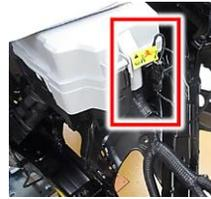
3. Apague el interruptor de encendido y desconecte la clavija auxiliar positiva (+) de la batería de 12 V (A).
