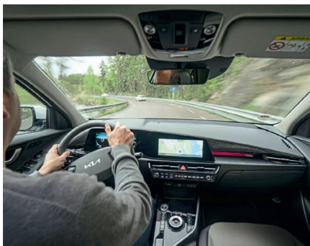
Übersichtlich: Cockpit mit Doppelbildschirm und reduzierter Tastenzahl.
