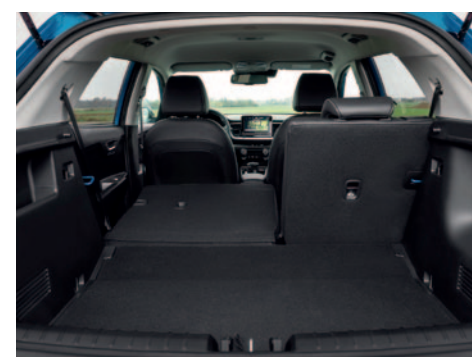
Technisch basiert der Stonic auf dem Kleinwagen Rio, sein Gepäckabteil ist im Vergleich aber ein kleines bisschen größer (325/1.103 zu 352/1.155 Liter).
