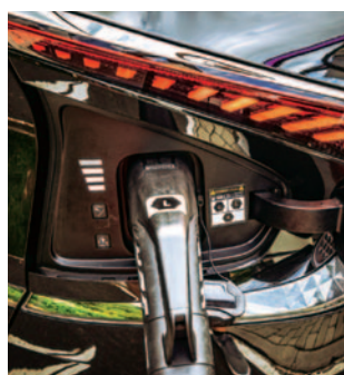
Die Ladebuchse ist hinten rechts unter der Rückleuchte. Dank 800-Volt-Technik lädt der Kia EV6 zügiger als andere.
