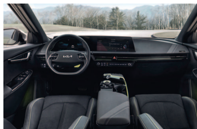
Ein breites Display, das aus zwei jeweils 12,3 Zoll großen Monitoren besteht, zieht sich bis zur Mittelkonsole.
