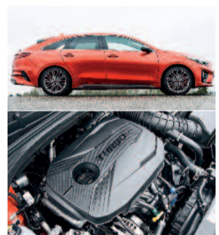
Der ProCeed wird von einem 1,6-Liter-Turbo mit 204 PS befeuert, der Vierzylinder ist ein munteres Kerlchen.
