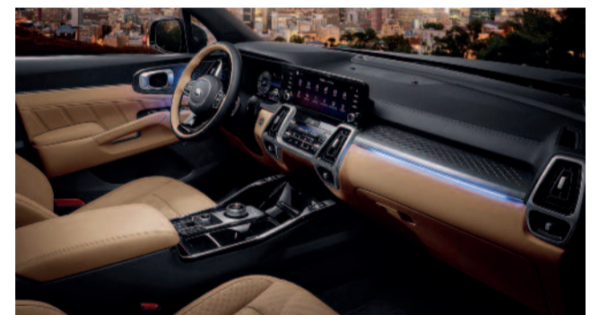
Die horizontal ausgerichtete Armaturentafel trägt ein großes Digitaldisplay mit 12,3 Zoll Bildschirmdiagonale vor dem Fahrer sowie über der Mittelkonsole einen, 10,25 Zoll großen Touchscreen.
