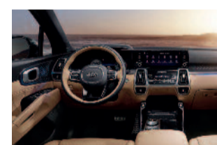
Die horizontal ausgerichtete Armaturentafel trägt ein großes Digitaldisplay mit 12,3 Zoll Bildschirmdiagonale vor dem Fahrer sowie über der Mittelkonsole einen, 10,25 Zoll großen Touchscreen.
