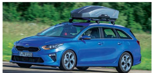
**FÜNF VOLLBREMSUNGEN** aus 130 km/h bis zum Stillstand steckt die vehement verzögernde Anlage locker weg. Bei Slalom und Spurwechsel greift das ESP mitunter kurz ein und korrigiert so rechtzeitig das sachte Drängen des Hecks.
