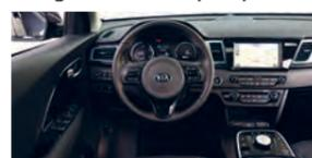
Spannendes Detail im Cockpit: Eine Lenkradwippe drosselt das Tempo. Dabei wird Energie gewonnen (Rekuperation).
