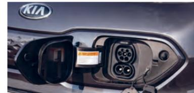
Die „Tankklappe“ mit zwei verschiedenen Anschlüssen für Wechselstrom und Gleichstrom.
