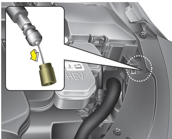
Wenn sich die Ladeanschlussklappe nicht öffnen lässt, weil die Batterie entladen ist, die Motorhaube öffnen und wie links dargestellt leicht am Notseilzug ziehen.
