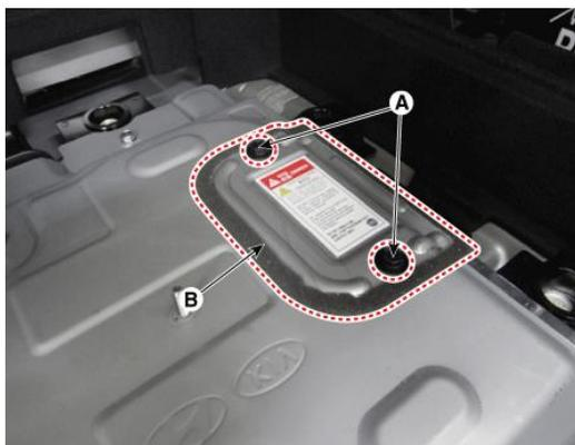
d) Hebel (A) lösen.
