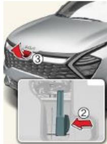
1. Entriegelungshebel (1) betätigen, um die Motorhaube zu entriegeln. Die Motorhaube sollte sich etwas öffnen.
