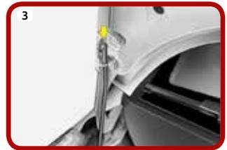
Entsichern Sie die Stützstange, und führen Sie sie in die abgebildete Öffnung ein.
