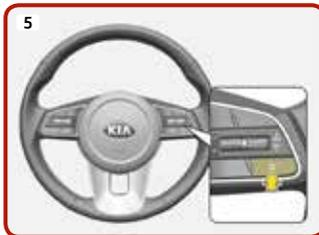
Tempomat-Steuerung mit der Abbruchtaste (0) unterbrechen
