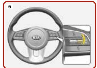
Hebel nach oben zur Position RES + ziehen, um die Tempomat-Steuerung wieder aufzunehmen
