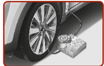
Mit dem Tire Mobility Kit bleiben Sie auch nach einer punktuellen Reifenpanne mobil. Nachdem Sie sich davon überzeugt haben, dass der Reifen ordnungsgemäß abgedichtet wurde, können Sie mit dem Reifen vorsichtig und mit einer maximalen Geschwindigkeit von 80 km/h bis zu 200 km weiterfahren, um eine Werkstatt zu erreichen, wo der Reifen ersetzt werden kann.
