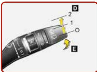
**D: Steuerung für Heckscheibenwischer/-waschanlage**
