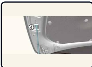
Haubenentriegelungshebel (1) ziehen. Entriegelungshebel der zweiten Verriegelungsstufe (2) nach links drücken. Motorhaube (3) anheben. Stützstange (4) herausziehen und die Motorhaube damit abstützen.
