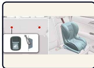
Kinderrückhaltesystem mit einem Halteband an einem oberen Ankerpunkt im Fahrzeug sichern [4]
