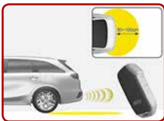
Die intelligente Heckklappe lässt ein Begrüßungssignal ertönen, wenn der Smart-Key innerhalb von 50 – 100 cm entfernt ist.
