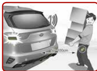
Die Warnblinker leuchten und das akustische Signal ertönt zweimal, dann öffnet sich langsam die Heckklappe.
