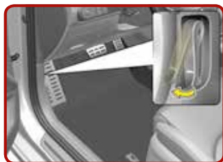
Motorhaube öffnen [4] Ziehen Sie den Entriegelungshebel, um die Motorhaube zu entriegeln.
